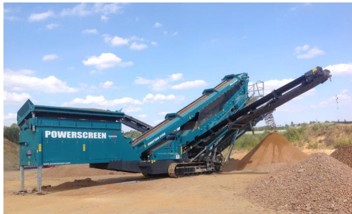
Die Powerscreen Chieftain 2200 im Einsatz. Das Haupt-Austragsband fördert Sand in 0 - 2 mm.
