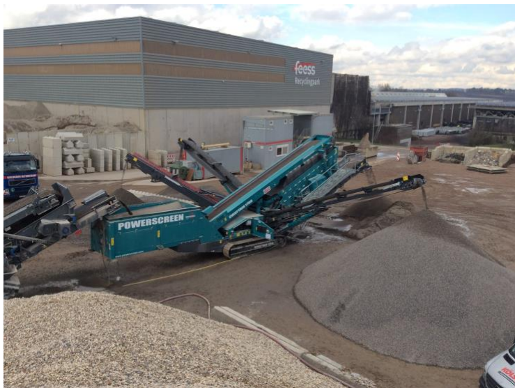
Powerscreen Chieftain 1700 mit drei Siebdecks, Austrag der vier Fraktionen über drei Seitenbänder und das Endband
