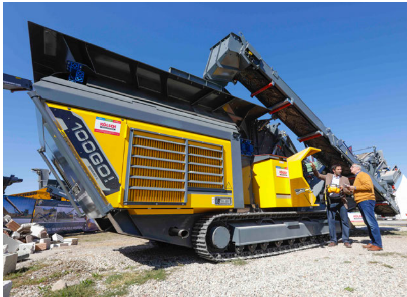
BU: Einer der derzeit modernsten, effizientesten und saubersten Brecher, der Prallbrecher Rubble Master RM100GO!
