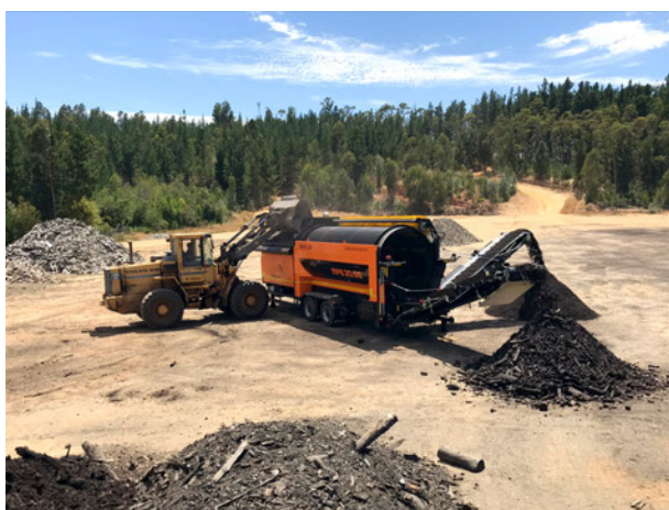
BU: Kompatibel mit den gängigen Trommeln: PRONAR Trommelsieb MPB 20.55
