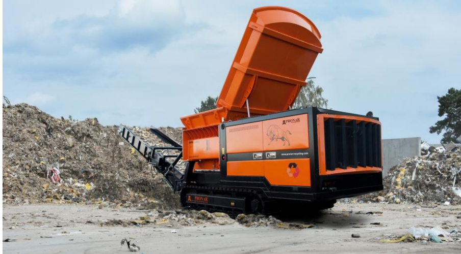
BU: PRONAR MRW2.85g in der kettenmobilen Ausführung, beim Zerkleinern von Sperrmüll
