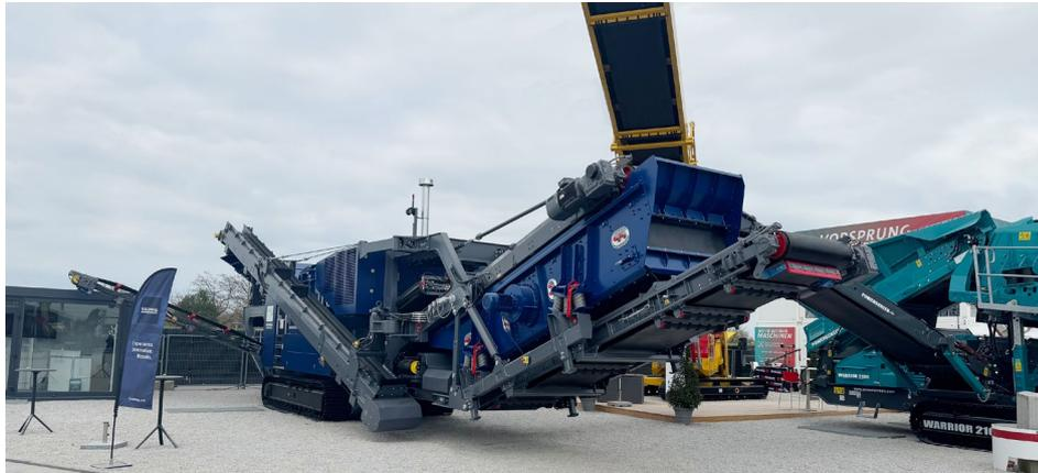
*BU: Hochmoderne Aufbereitungstechnik „Made in Germany“ mit einem Durchsatz von bis zu 350 t/h: Der HAZEMAG Prallbrecher dynamox I-120. Im Hintergrund weitere Maschinen aus dem KÖLSCH/CHRISTOPHEL Portfolio.*
