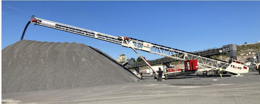
BU: *Das Telestack TSR40 sorgt für eine um eine bis zu 30% größere Haldenkapazität im Vergleich zu Bändern mit fixer Bandlänge.*
