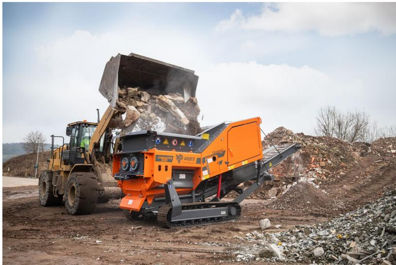
**BU:** *Alleskönner im Kompaktformat: Im Einsatz verzeichnet der ARJES Compaktor 300 eine Länge von 7,8 m, eine Breite von 2,3 m und eine Höhe von 3,7 m. Für den Transport lassen sich Höhe und Länge auf 2,6 m x 7,2 m verringern.*
