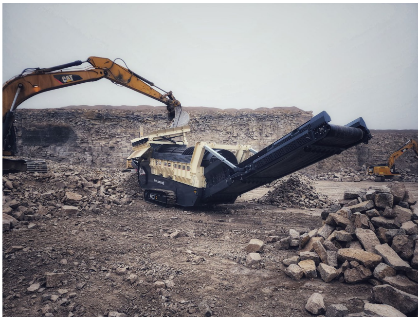
BU: Die kompakte, transportfreundliche MDS M413 im Einsatz, ihr maximaler Output liegt bei 400 t/h.
