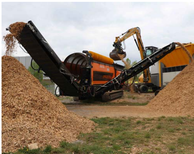
BU: Raupenmobiles Trommelsieb MPB 20.55GH von Pronar: dank fein ansteuerbarer Hubkinematik auf jedem Untergrund im Lot
