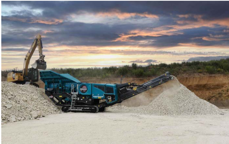
BU: Der raupenmobile Backenbrecher Premiertrak 400X von Powerscreen: gut für eine Durchsatzleistung von bis zu 400 t/h
