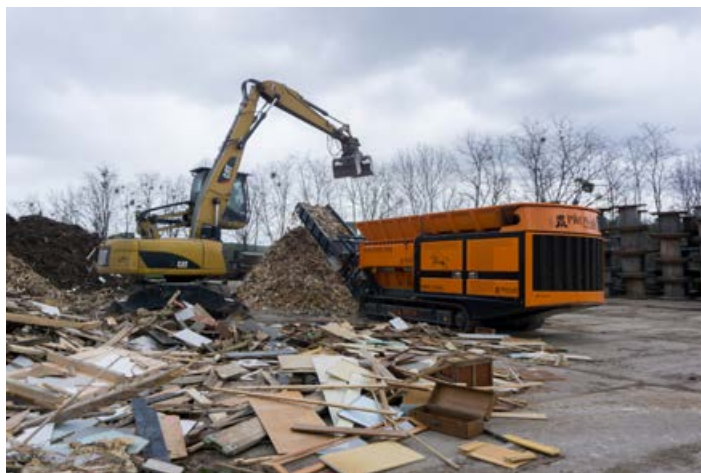
BU: Einer der derzeit größten Vorzerkleinerer von Pronar, der MRW 2.1010 an seinem Einsatzort in Dresden.
