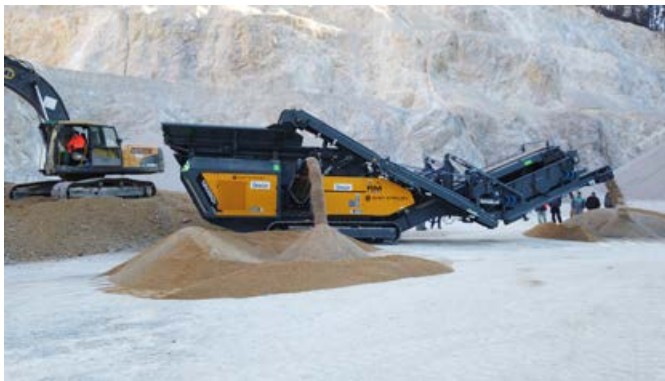
BU: RUBBLE MASTER RM120GO! mit Nachsieveinheit MS125 im Natursteinseinsatz
