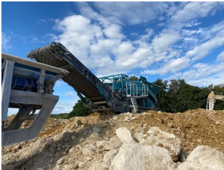
BU: Die großen, von adhäsiven Kontaminationen weitgehend befreiten Kalkstein-Bruchstücke werden einem Primärbrecher zugeführt.
