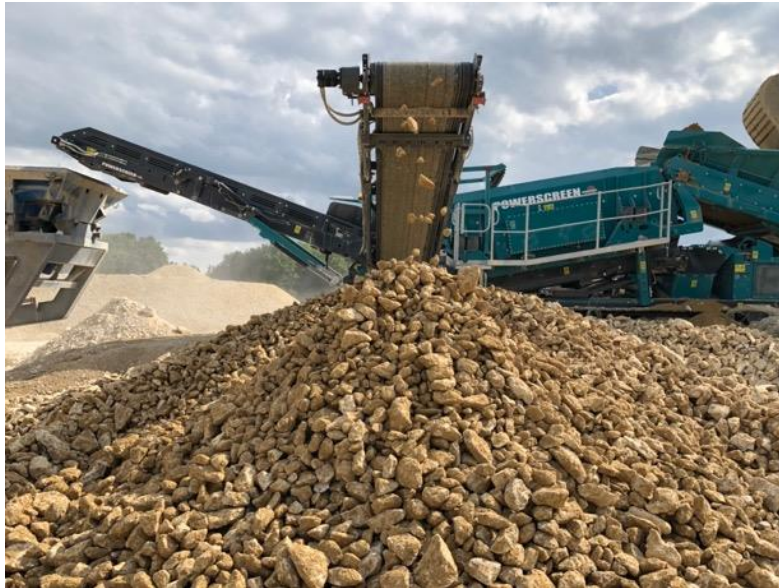
BU: Die Halde des Seitenaustragsbandes zeigt ein sauberes, homogenes Ergebnis.
